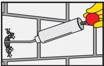
Il foro deve essere pulito con aria compressa o pompa di soffiaggio (almeno 2x). Importante: impiegare dispositivi ad aria compressa senza olio.
