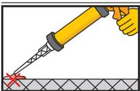
Per ogni cartuccia nuova, oppure dopo aver cambiato il miscelatore statico, le prime estrusioni non possono essere utilizzate, fino a che non si consegue un colore uniforme.
